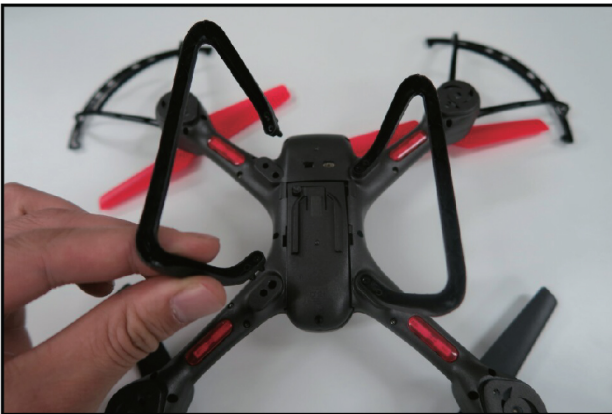
STEP 1 : 쿼드콥터 밑면에 랜딩스키드를 설치합니다.
